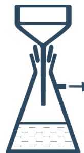
Гуч који је постављен на гуч-боцу и прикључен на водену пумпу
