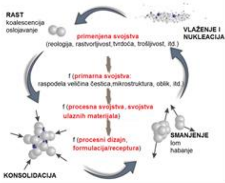
Slika 1. Mehanizmi procesa mokrog granulisanja
